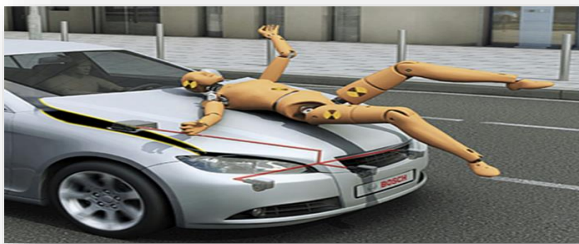
شکل ۱۳: سیستم حفاظت از عابر پیاده به هنگام تصادف
